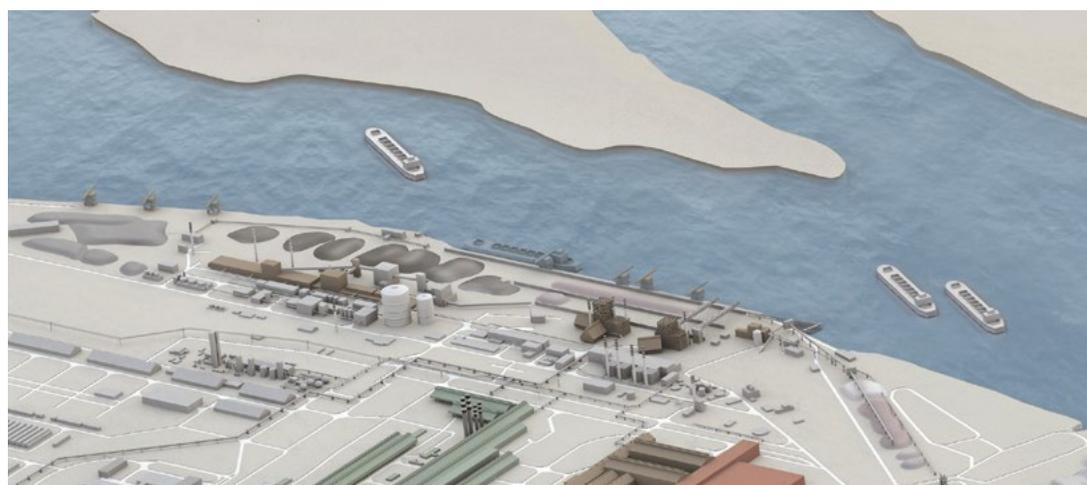
**E**l objetivo de la inversión fue captar los efluentes líquidos que provienen de la Coquería, del sector de subproductos y parte de los pluviales, antes de su llegada al río por el llamado vuelco N° 2. El sistema se encuentra en funcionamiento desde enero de este año.
